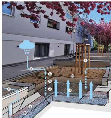
kornabgestuftes Baumsubstrat mit Abdichtung
